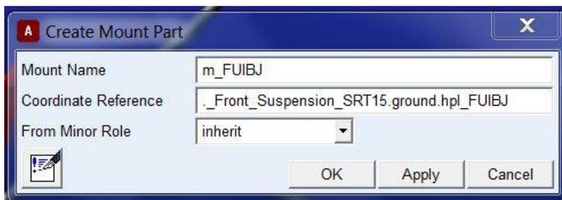
Lo stesso procedimento è applicato per i seguenti **mount parts**: Triangolo inferiore, attacco sterzo, attacco bellcrank - scocca , attacco smorzatore – scocca.
