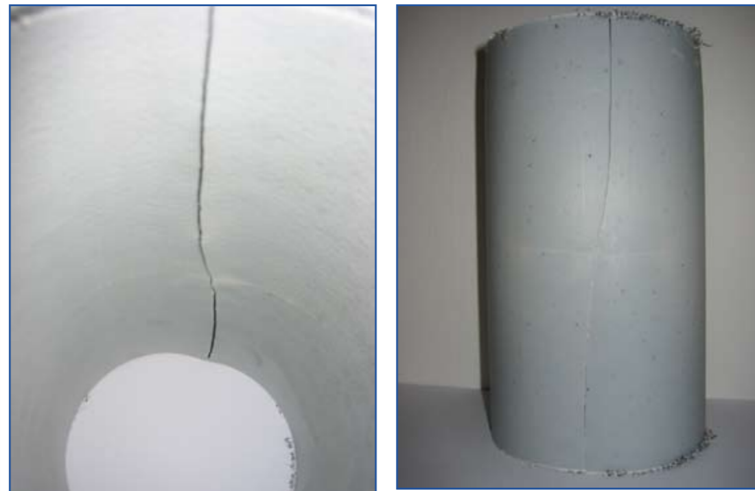
Figura 2. Esempio di frattura su campioni di laboratorio.
