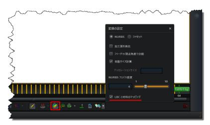
▶ 上記の処理が行われた MSC Apex Generative Design のデータベースを MSC Apex で開くことができます。MSC Apex では、荷重と拘束と材料情報がマッピングされた設計 候補の形状にメッシュを作成し、直接 FE シミュレーションを実行して設計候補を詳細に 検証することができます。
